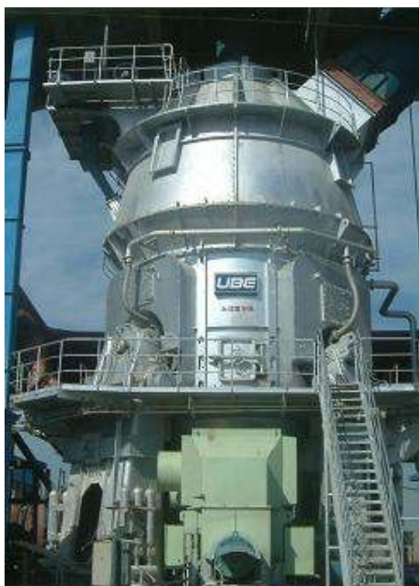
图片：唐龙二线采用的日本宇部（UBE）UM46.4SN 立式磨机
