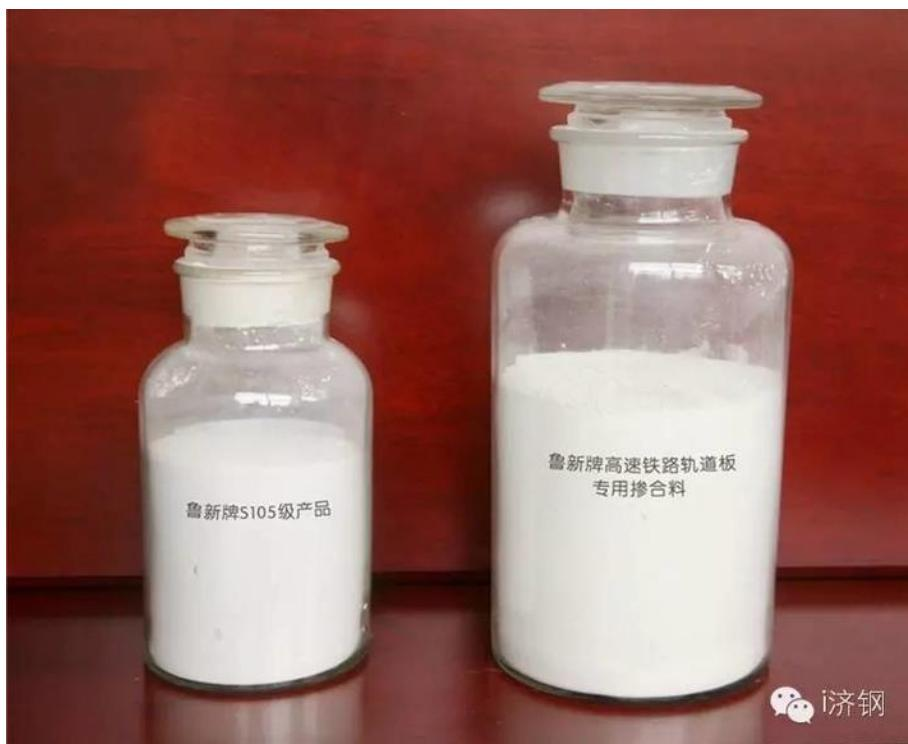
高速铁路轨道板生产对材料的要求非常高，相关技术标准明确要求，掺合料1天活性指数必须大于125%，28天活性指数必须大于110%，需水量必须小于105%，而国内尚无单一材料可满足此要求。面对技术难题，鲁新公司强力攻关，成功开发出高速铁路轨道板专用掺合料，不但各项性能指数达标，而且混凝土搅拌性好，可满足轨道板生产现场的连续生产，产品已成功应用到了京沪、哈大、沪宁杭等高速客运专线建设。专家认为该项技术可明显提高混凝土耐久性能和早期强度，整体技术达到国际先进水平。
