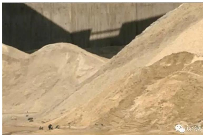
矿渣粉，即粒化高炉矿渣粉，是由符合 GB/T203 标准规定的粒化高炉矿渣，经干燥、粉磨，达到相当细度且符合相当活性指数的粉体。作为一种优质的混凝土和水泥功能掺合料，可等量替代 30%—75% 水泥制备高高性能混凝土和低碳水泥必要组分；能有效降低 CO<sub>2</sub>、NOX 等有害气体排放，减排二氧化碳接近高达 80%，真正实现低碳绿色发展。此外，还具有延长建筑寿命、大幅降低建筑成本、灵活控制混凝土凝固时间、有效抵抗外界酸碱盐的侵蚀、降低混凝土离析几率、色泽浅白可减少城市热岛效应等作用，是节能、绿色、环保的新型建筑材料。
